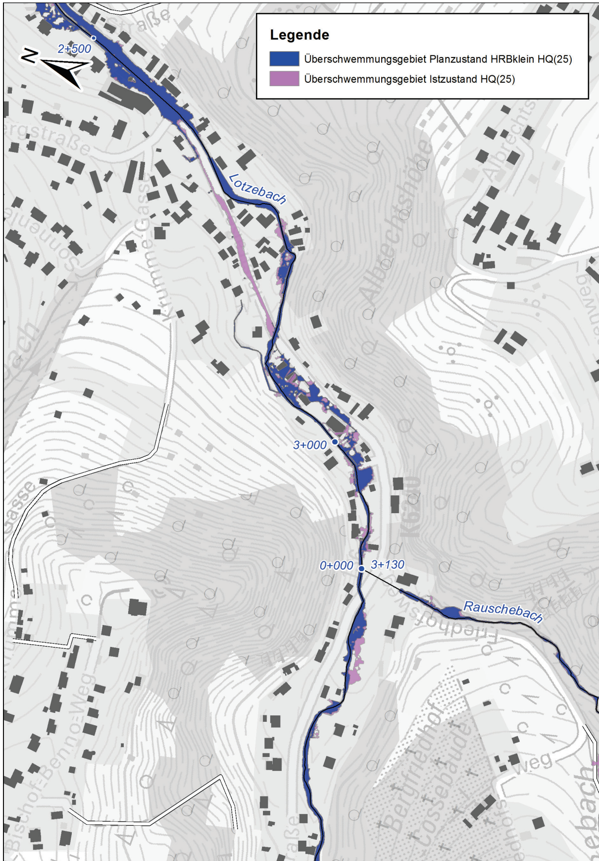
Abbildung 7.3: Mit einem Stauvolumen von 17.000 m 3 vor der Mündung des Rennersdorfer Dorfbachs bei HQ(25) verhinderbare Überflutungen am Lotzebach, Bild 1 / 2
