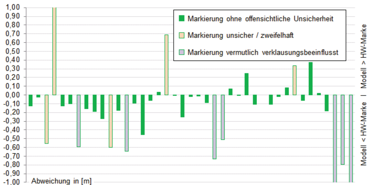
Abbildung 4.2: Übersicht zu den nach der Modellkalibrierung verbleibenden Abweichungen zwischen den berechneten Wasserständen und den HW-Marken vom Mai 2014
